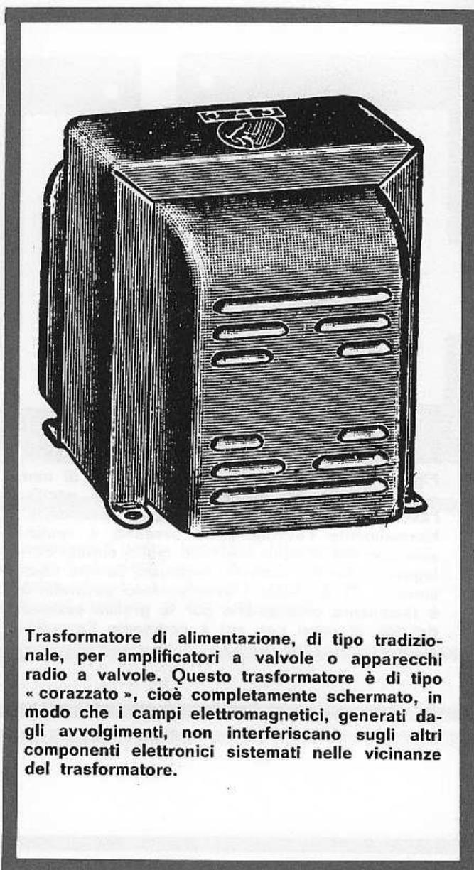
Trasformatore di alimentazione, di tipo tradizionale, per amplificatori a valvole o apparecchi radio a valvole. Questo trasformatore è di tipo « corazzato », cioè completamente schermato, in modo che i campi elettromagnetici, generati dagli avvolgimenti, non interferiscano sugli altri componenti elettronici sistemati nelle vicinanze del trasformatore.
